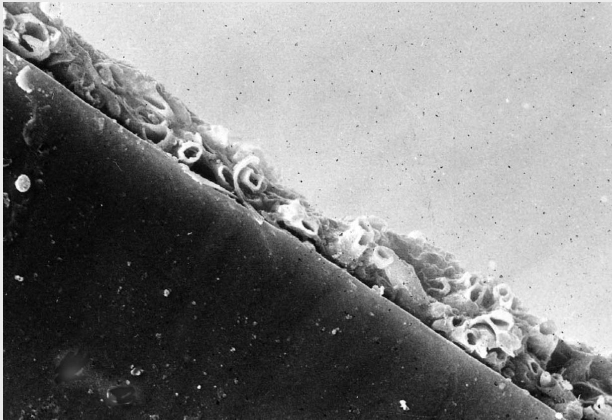
Abb. 1: Biofilm im Zulaufschlauch zu einem Dialysegerät (REM)
